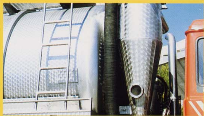
Filtro ciclone per la protezione della pompa di vuoto / Vacuum pump protecting cyclone filter / Filtre cyclone pour la protection de la pompe de vide.
