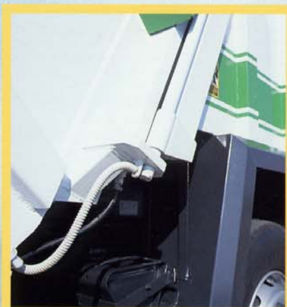
Sistema di bloccaggio idraulico della bocca di carico al cassone con sensori elettronici di sicurezza / Tailgate hydraulic locking device with safety electronic sensors / Système de blocage de la tremie de chargement par des capteurs électroniques de sécurité.
