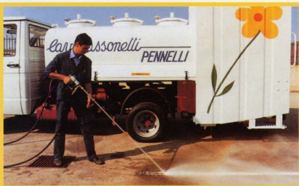
Lancia per idrosabbatura che permette la cancellazione di scritte e rimozione dello sporco più ostinato / Jet for water sandblasting to erase signs and clean up the most persistent dirt / Lance de sablage pour l'effacement d'inscriptions.
