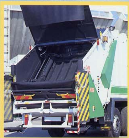
Cappa antipolvere ad apertura automatica in sequenza con voltacassonetti / Automatic sequential opening dust cover with bin-lifting device / Protection antipoussière à ouverture automatique en séquence avec le lève conteneurs.
