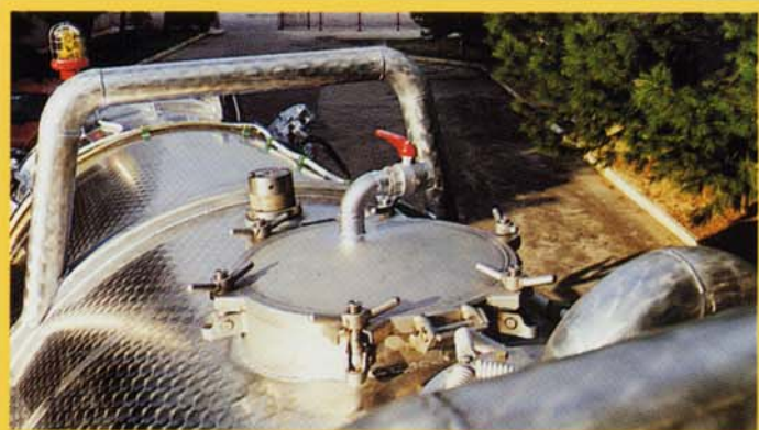
Passo d'uomo. Valvola di sicurezza per massima pressione e rompuvuoto. Roll bar superiore di protezione. Faro antideflagrante / Manhole. Maximum pressure safety valve and vacuum breaker. Upper protecting roll bar. Explosion-proof light / Trou d'homme. Vanne de sûreté pour la pression maximum et coupe-vide. Roll bar supérieur de protection. Feu antidéflagrant.
