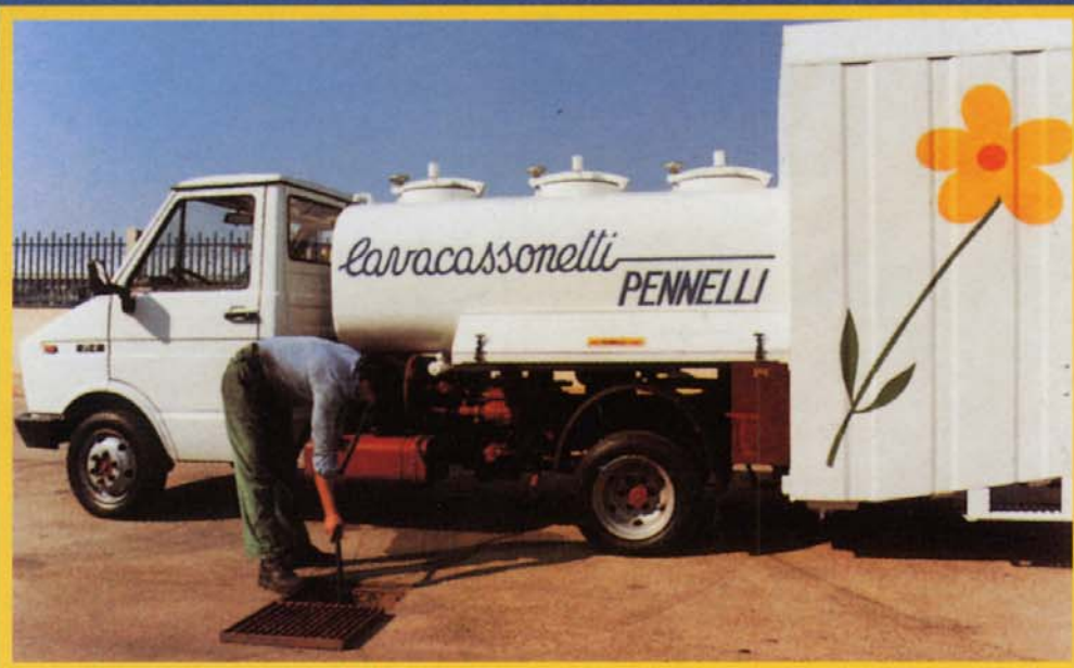
Pulizia e stasamento in un pozzetto di condotta fognaria / Cleaning and emptying of sewage cesspits / Nettoyage et désobstruction d'un puisard d'égout.
