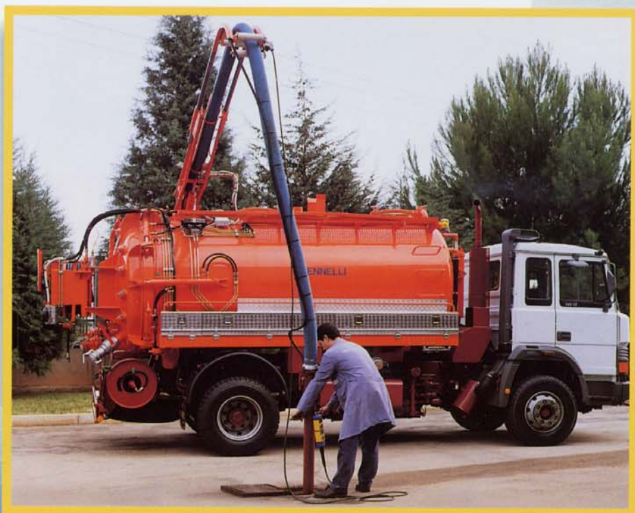
Fase di aspirazione da pozzetto stradale con proboscide / Suction phase through boom from a trap
