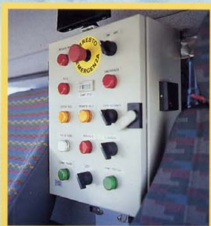
Sistema computerizzato di monitoraggio e diagnostica dell'attrezzatura posto in cabina / Computerized system to monitor and diagnose the equipment located inside the cab / Computer placé dans la cabine pour le monitoring et le diagnostic de l'équipement.
