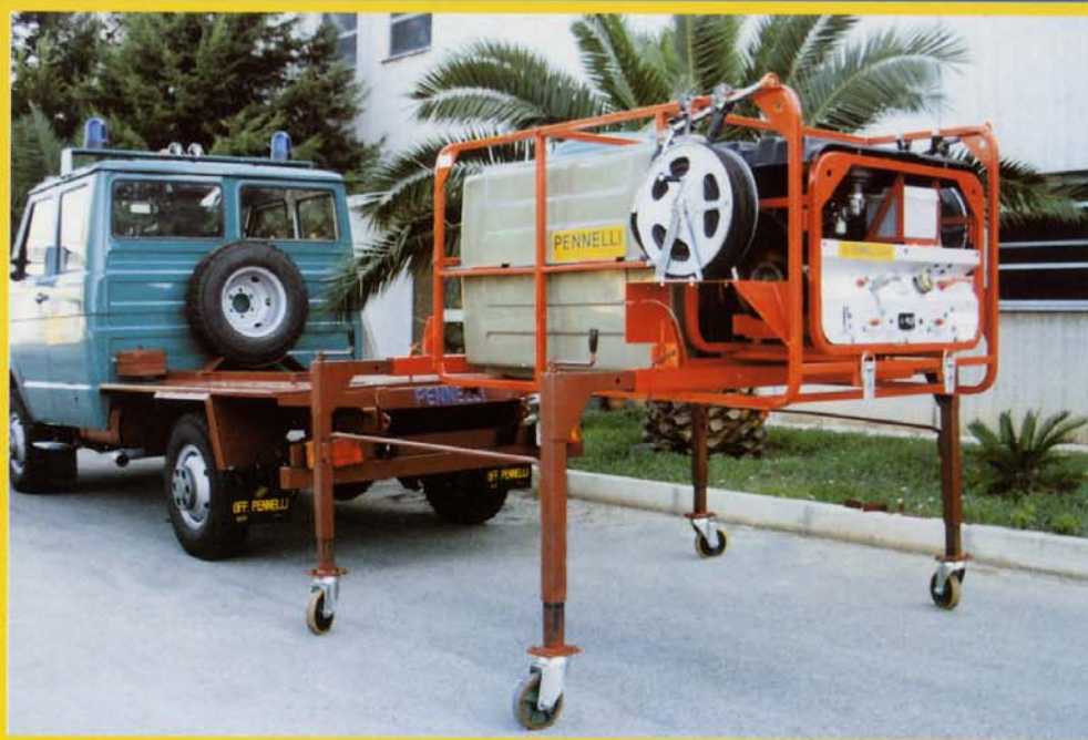
Modulo scarrabile anticendio di primo intervento dotato di motore ausiliario per l'azionamento della pompa ad alta pressione / First aid releasable fire unit equipped with auxiliary engine for high pressure pump driving / Module dételable de premier secours équipé de moteur auxiliaire pour l'actionnement de la pompe à haute pression.
