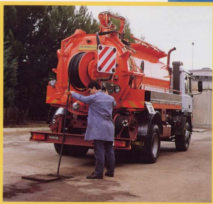
Disotturazione canalizzazioni con sistema idraulico / Sewerage hydraulic cleaning / Nettoyage des égouts par système hydraulique.
